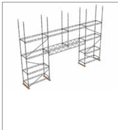
Fagverksdrager i stål
