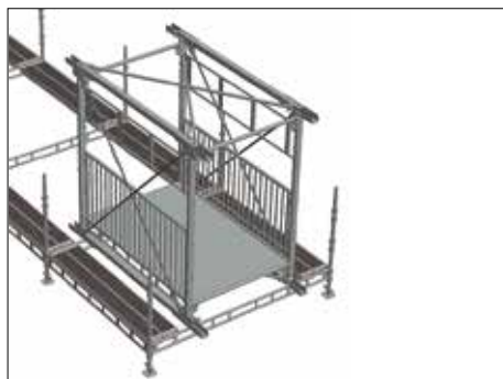
17. Fjern alle midlertidige rekkverksrammer og monteringsplattformer. Bruk de fjernede komponentene til å montere neste fag på HBS.
